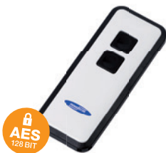
Handsender Mini-Novotron 522 2-Kanal, 433 MHz, KeeLoq-Wechselcode
