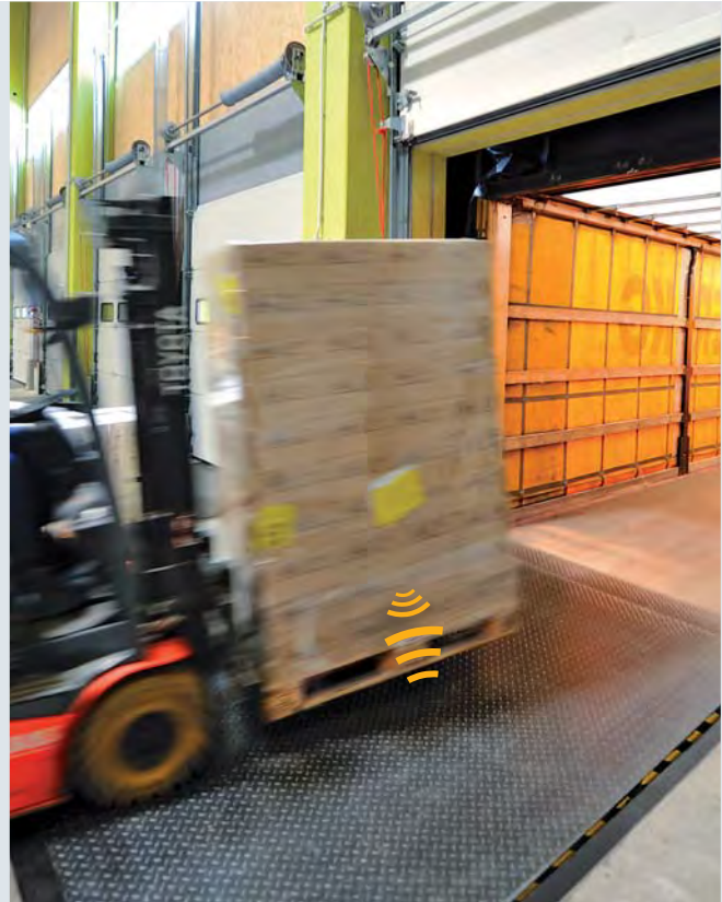
Automatisches Erfassen von Warenbewegungen, einfach beim Überfahren der Ladebrücke.
