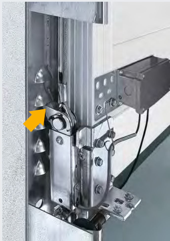
Der Verriegelungshaken der Aufschiebesicherung rastet beim Hochhebeln des Tores automatisch fest ein.
