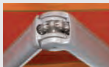
Die Hochleistungsflyerkette sorgt für Stabilität im Mittelgelenk.
